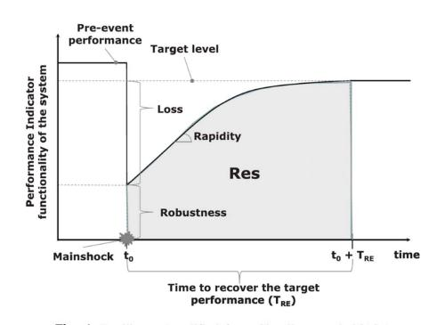
$$R(\vec{r}) = \int_{t_{\rm OE}}^{t_{\rm OE} + T_{\rm LC}} Q_{\rm TOT}(\vec{r}, t) / T_{\rm LC} dt$$
